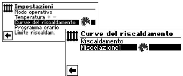
Lo schermo cambia nel menù "Curva circ.misc. 1". Le curve del riscaldamento possono essere programmate sempre che non sia definita una temperatura fissa.
