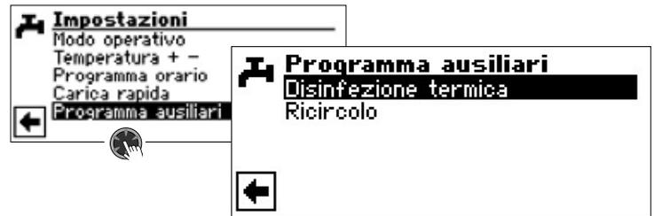
La disinfezione termica consente di innalzare la temperatura dell'acqua calda sanitaria ad una temperatura superiore a quella raggiungibile con una pompa di calore utilizzando un secondo generatore di calore (ZWE). La disinfezione termica viene preparata esclusivamente tramite secondi generatori di calore; il compressore della pompa di calore rimane spento.
