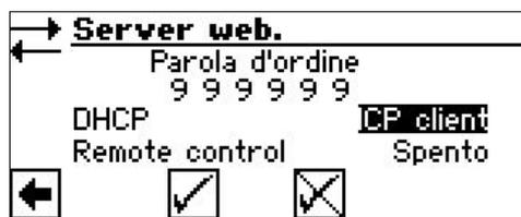
La regolazione del riscaldamento e della pompa di calore riceve automaticamente i dati di collegamento dal server DHCP (ad es. router).
