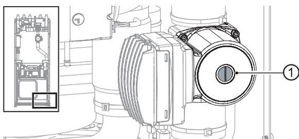
3. Inserire un cacciavite nell'apertura e rilasciare l'albero bloccato nel senso di rotazione della pompa di circolazione.
