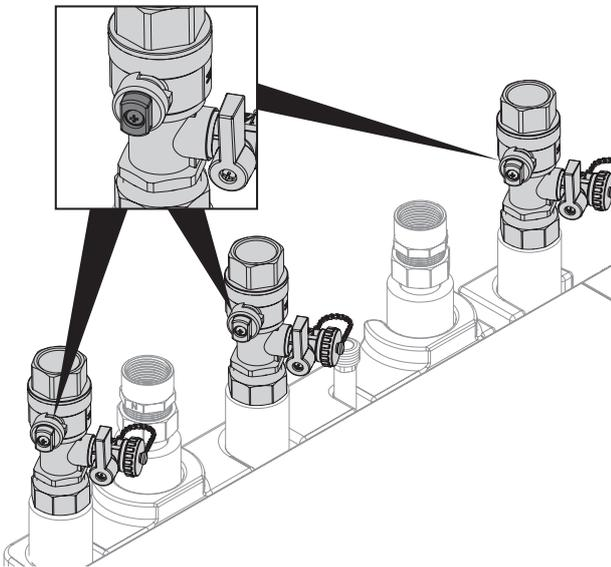
3. Svuotare l'apparecchio mediante i rubinetti di riempimento e di svuotamento del riscaldamento.
