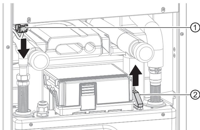
7. Rimuovere gli isolamenti dalle connessioni idrauliche.
