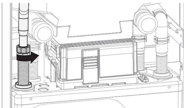
10. Staccare i raccordi idraulici premendo sui tubi quanto occorre.
