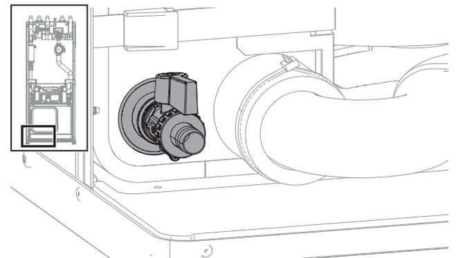
4. Chiudere i rubinetti d'intercettazione della fonte di calore (dietro le coperture) con una chiave fissa.
