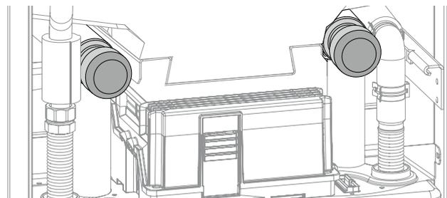
5. Svotare l'apparecchio mediante i rubinetti di riempimento e di svuotamento della fonte di calore.
