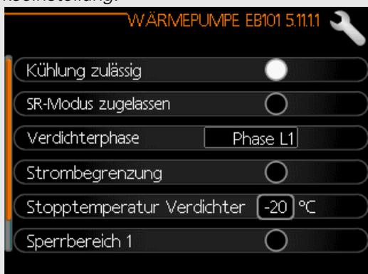
Standardmäßig ist die Zweirohrkühlung eingestellt. Um den Kühlbetrieb auf eine Vierrohrkühlung umzustellen, muss diese in Menü 5.2.4 aktiviert werden.
