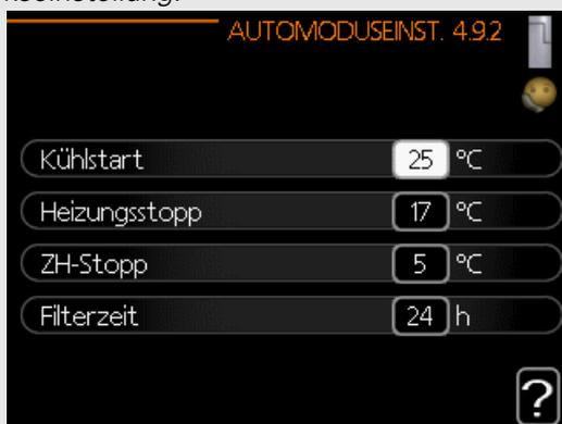
Falls die per „Filterzeit“ berechnete mittlere Temperatur die eingestellte Temperatur übersteigt, startet die Kühlung gemäß den Einstellungen in Menü 1.9 (Untermenüs 1.9.1.2 und 1.9.3.2.).
