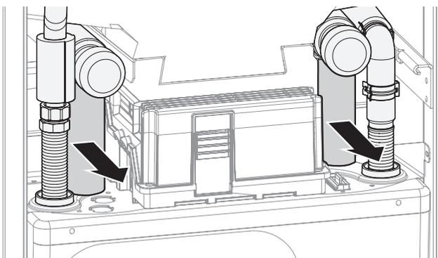
8. 3 Klammern an den Hydraulikverbindungen entfernen.
