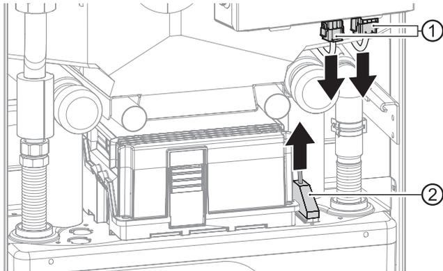
7. Isolierungen an den Hydraulikverbindungen abnehmen.
