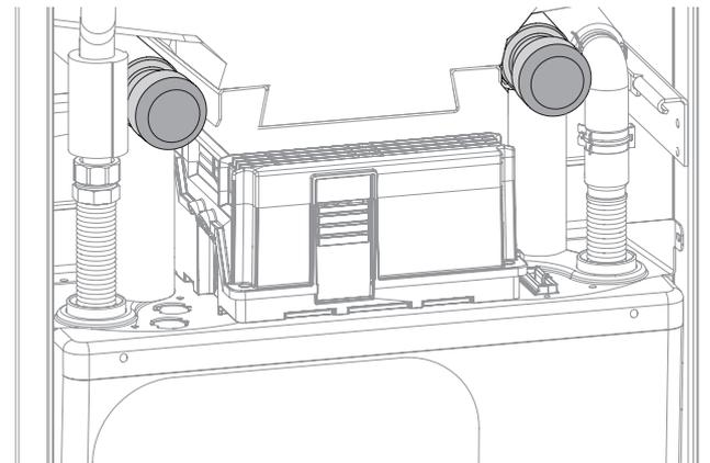
5. Gerät über den Füll- und Entleerhahn Wärmequelle entleeren.
