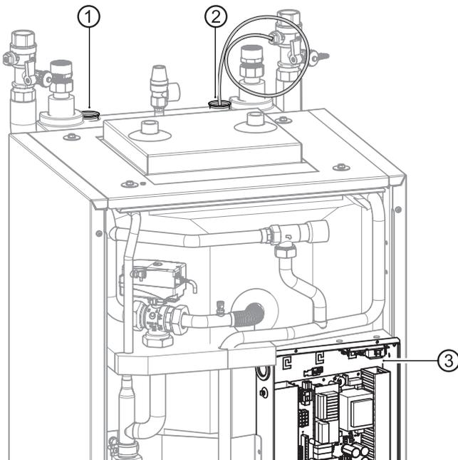
4. Leitungen von unten durch die Kabelöffnungen in den Schaltkasten (③) führen.
