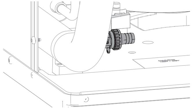
4. Absperrungen zur Wärmequelle (hinter den Abdeckungen) mit Schraubenschlüssel schließen.
