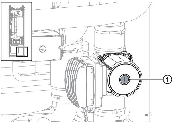
3. Schraubendreher in die Öffnung einführen und in Drehrichtung der Umwälzpumpe blockierte Welle lösen.
