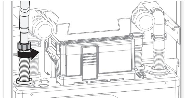
10. Hydraulikverbindungen trennen, dazu die Rohre so weit wie nötig auseinander drücken.
