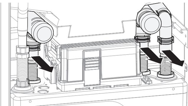
9. Heizungsvorlauf mit Schraubenschlüssel SW 37 auseinander schrauben.
