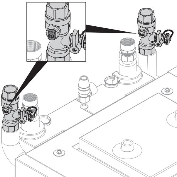
3. Gerät über den Füll- und Entleerhahn Heizung entleeren.
