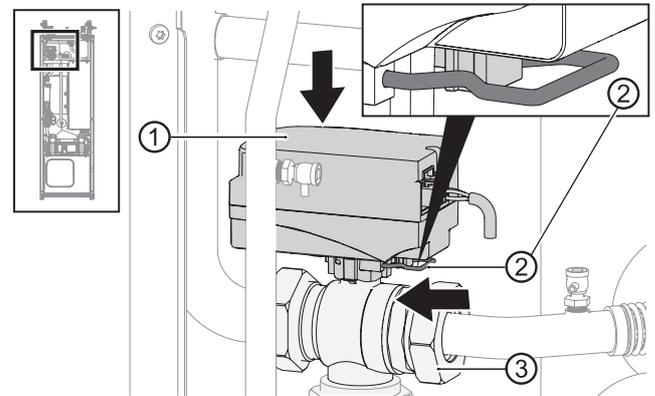
9. Sicherstellen, dass der Bügelstift korrekt eingearastet ist:
