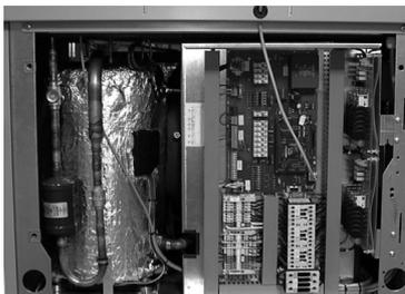
Beispiel eines geöffneten elektrischen Schaltkastens
