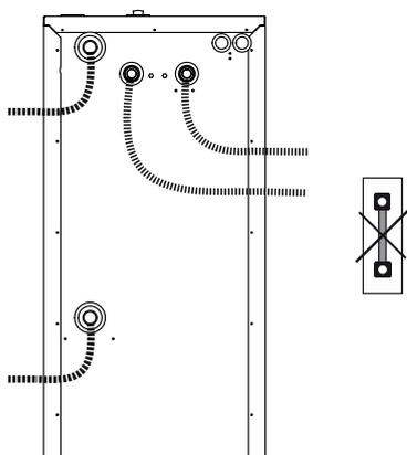
Eine gerade oder gestreckte Schlauchverlegung der Schwingungsentkopplungen ist nicht zulässig.
