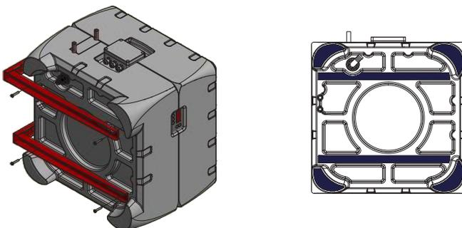
Schrauben dürfen ausschließlich an den dunkel dargestellten Bereichen angebracht werden. Max. Schraubenlänge 40 mm.
