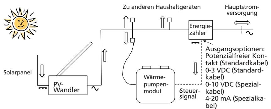
Aufbau der PV-Steuerung mit des Signals vom Energiezähler.
