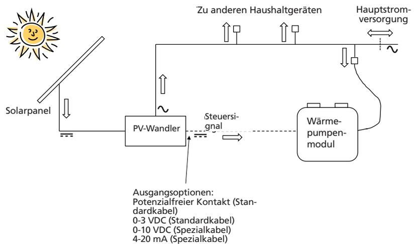
Aufbau der PV-Steuerung mit des Signals vom Solarwechselrichter.
