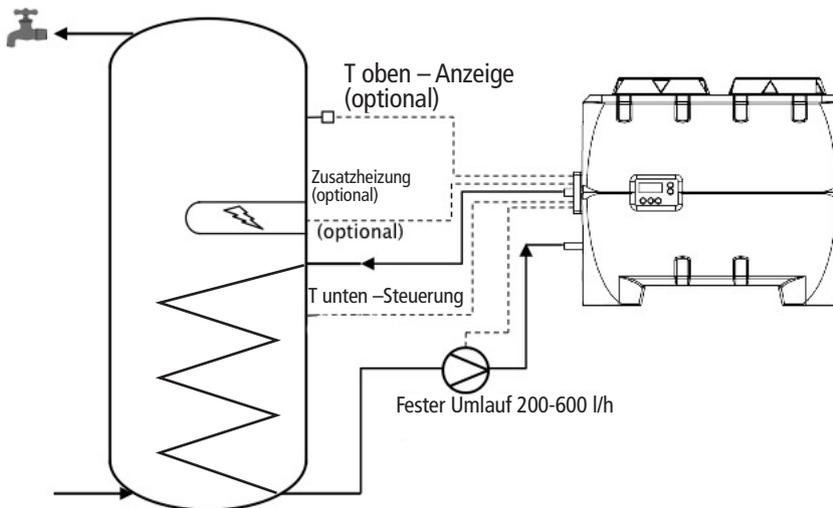
Das WPM erhitzt das Wasser durch wiederholtes Umwälzen, bis die eingestellte Temperatur erreicht ist. In der Regel sind 5-15 Durchläufe erforderlich, um einen Wassertank mit kaltem Wasser vollständig zu erhitzen.
