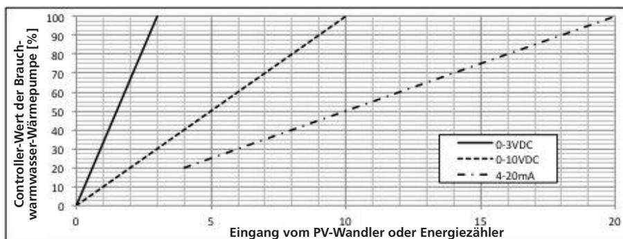
Umwandlung von Eingangssignalen in Prozentwerte, die in E30 und E31 verwendet werden. Es sind spezielle Kabel für 0-10-VDC-Eingänge und 4-20-mA-Eingänge erforderlich.
