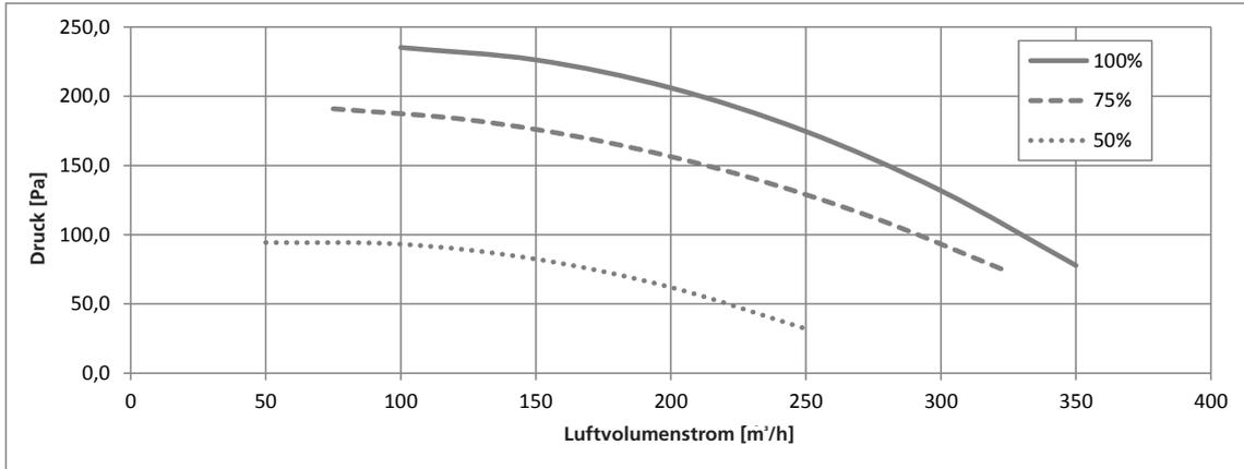
Es wird empfohlen, den externen Druckverlust unter 100 Pa zu halten.
