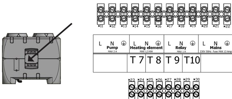
Der Temperatursensor T8 ist der Sensor für die Start/Stopp-Steuerung der Wärmepumpe. Der T8-Sensor ist in einer solchen Höhe am Wassertank zu installieren, dass sich noch genügend warmes Reservewasser über dem Sensor befindet, jedoch darf er nicht so niedrig angebracht werden, dass die Wärmepumpe jedes Mal startet, wenn warmes Wasser entnommen wird.
