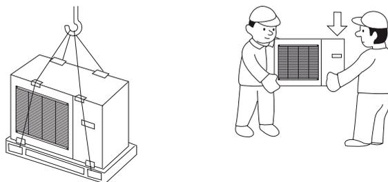
Wenn LSplit auf einer weichen Unterlage transportiert werden muss, z.B. über eine Rasenfläche, empfehlen wir die Nutzung eines Kranwagens, der die Einheit an den Aufstellungsort heben kann. Beim Anheben von LSplit per Kran muss die Verpackung am Produkt verbleiben und die Last ist per Ausleger zu verteilen, siehe Abbildung oben.
