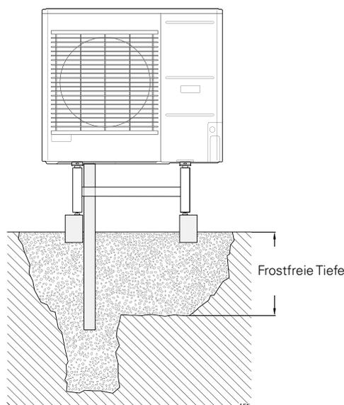
Wenn das Haus über einen Keller verfügt, ist die Kiesverfüllung so zu platzieren, dass das Kondenswasser keine Gebäudeschäden verursacht. Andernfalls kann sich die Kiesverfüllung direkt unter der Wärmepumpe befinden.
