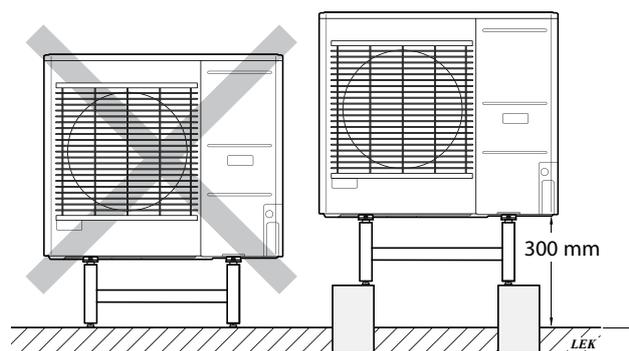
Stellen Sie die L Split Wärmepumpe nicht direkt auf dem Rasen oder einem anderen instabilen Untergrund auf.
