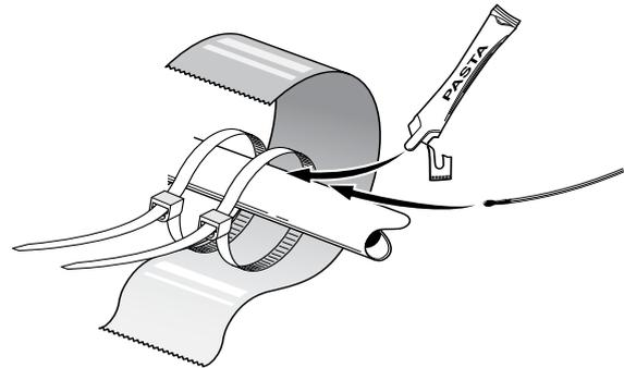
Die Temperatursensoren werden mit Wärmeleitpaste, Kabelbindern und Aluminiumband befestigt (der erste Kabelbinder wird am Rohr in der Mitte des Sensors angebracht, der zweite ca. 5 cm hinter dem Sensor). Man sollte sie dann mit Isolierband isolieren.
