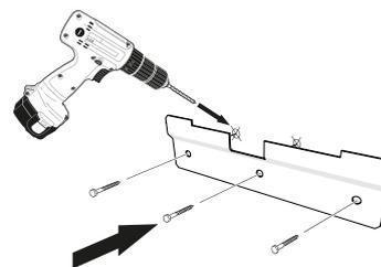
2. Bohren sie die Bohrlöcher mit den passenden Bohrer.
