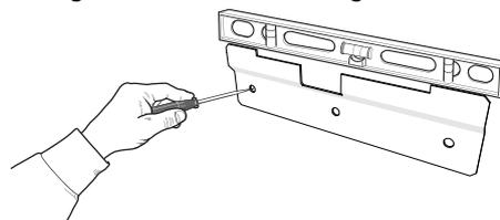
1. Richten Sie die Wandhalterung mithilfe einer Wasserwaage waagrecht an die Wand aus. Markieren Sie die Bohrlöcher.
