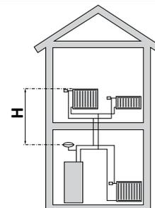
Wenn der Standardanfangsdruck im Ausdehnungsgefäß zu niedrig ist, kann er durch einfüllen von Druckluft über das installierte Ventil erhöht werden. Der Standardanfangsdruck des Ausdehnungsgefäßes muss in die Checkliste auf Seite 5 eingetragen werden.
