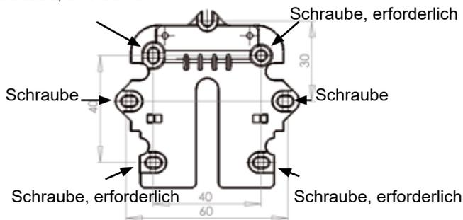
Halten Sie den Wandrahmen an die Wand und markieren Sie die Schraubenlochpositionen zur Befestigung des Rahmens. Das Bohren von Löchern, die Lochgröße und die verwendeten Schrauben zur Befestigung des Bedienfelds müssen dem Wandmaterial entsprechen.
