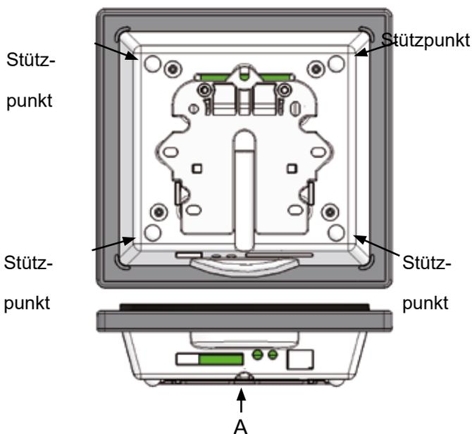
Unten am Bedienfeld befindet sich ein Zugang für: A: Klemmenblock. Anschluss an Hauptplatine
