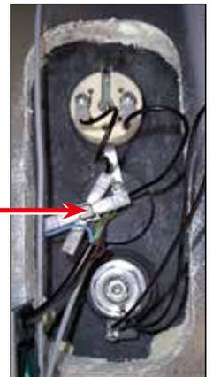
Beim Zurücksetzen (Reset) wird die weiße Taste gedrückt.
