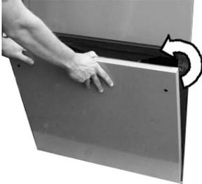
3. Schrauben an der Unterseite der oberen Fassadierung entfernen.
