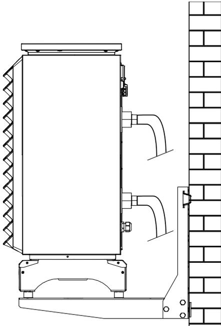
Beispiel hydraulische Verbindung
