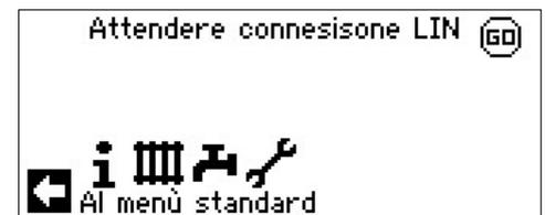
scollare la regolazione del riscaldamento e della pompa di calore dalla tensione di rete, controllare il cavo tripolare per il collegamento al BUS ed eventualmente eliminare il guasto.
