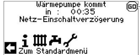
Durch Ansteuern und Anklicken von „GO“ wird der Inbetriebnahme-Assistent aufgerufen. Dieser führt Sie bei der Erstinbetriebnahme durch die wichtigsten Einstellungen der Regelung.
