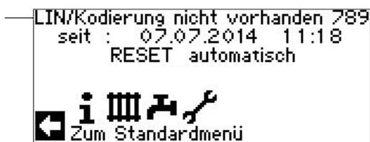
Beispiel eines im Bildschirm angezeigten Verbindungsfehler
