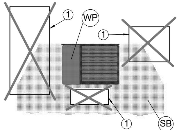
Abbildung: Sicherheitsabstände zur Wärmepumpe
