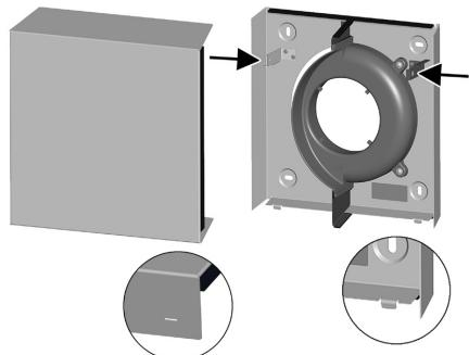
1. Frontabdeckung von unten auf das Gehäuse setzen – die beiden Slits der Frontabdeckung müssen in die Gehäusenäsen einrasten. Gehäuse nach oben schwenken und seitlich rechts und links festschrauben (→ Pfeile).
