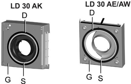
4. Sur le côté du boîtier tourné vers le mur [G] : placer à l'intérieur tout autour de la bague d'étanchéité [D] une bague en silicone [S] supplémentaire. Celle-ci permet d'assurer l'étanchéité avec le mur extérieur.
