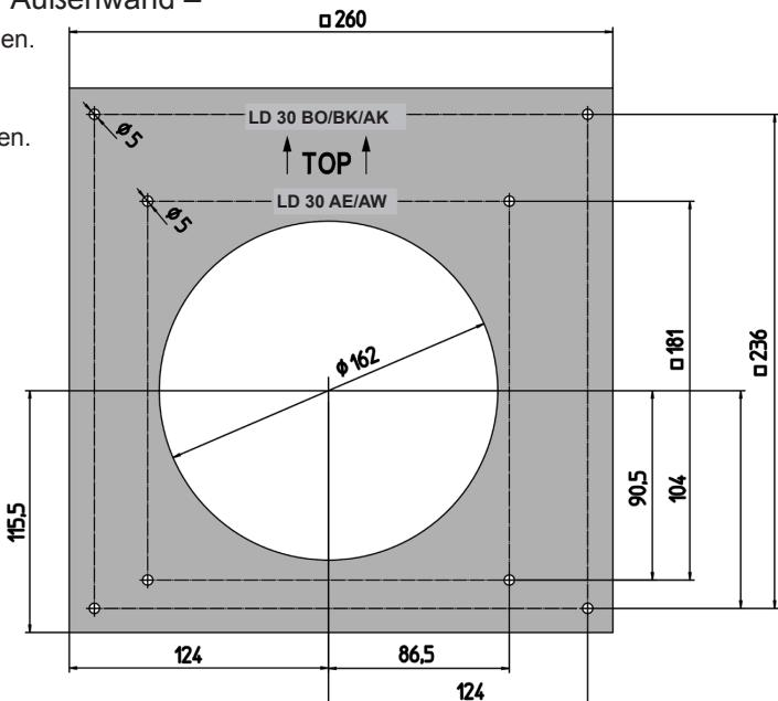
1. Putzschutzdeckel entfernen, Bohrschablone über die Wandhülse setzen, ausrichten und Befestigungslöcher markieren.
