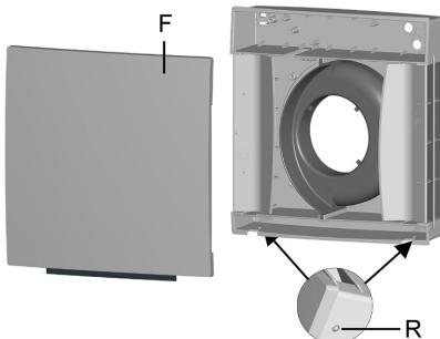
1. Frontabdeckung von oben auf das Gehäuse setzen und nach unten schwenken. Die Frontabdeckung muss unten an den beiden Rasthebeln [R] hörbar einrasten.
