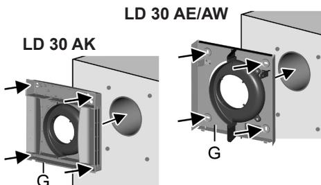
5. Gehäuse [G] mit 4 Schrauben an der Außenwand festschrauben. Geeignetes Befestigungsmaterial ist bauseitig bereitzustellen.
