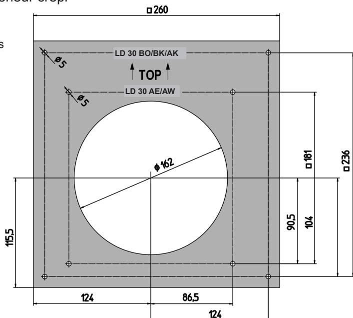
1. Retirer le couvercle de protection du crépi, placer le gabarit de perçage sur la gaine murale, orienter et marquer les trous de fixation.
